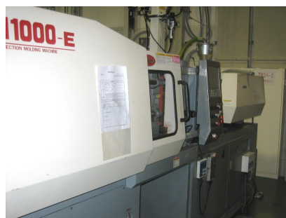
マグネットクランプを使用した状態。金型固定の爪が不要
