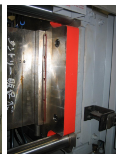
マグネットクランプを使用した状態。金型固定の爪が不要
